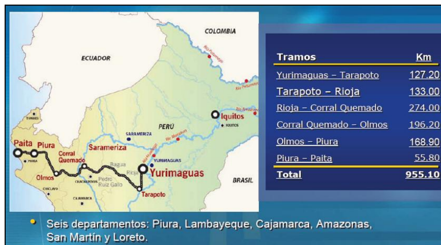
Figura 21. Tramos en km de la carretera IIRSA Norte (Transoceanic) Fuente: IIRSA Norte.com (2010)
