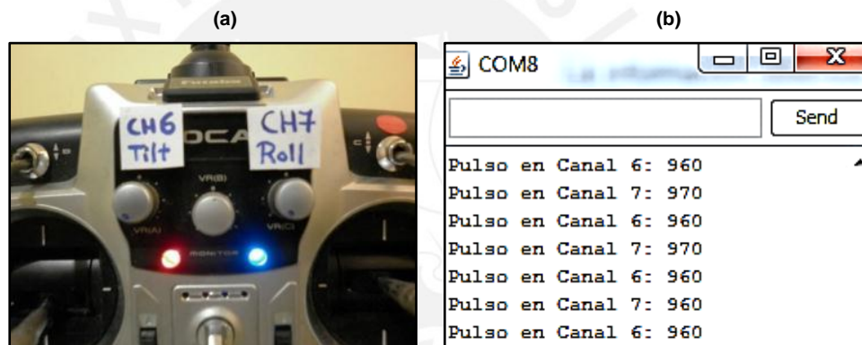
Figura 4.10: (a) Perillas colocadas al mínimo en transmisor, (b) ancho de pulso (en us) leído por microcontrolador.
