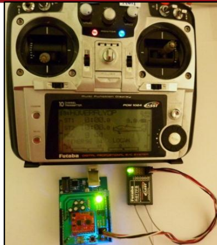
Figura 4.9: Conexiones para pruebas de comunicación de receptor con microcontrolador.
