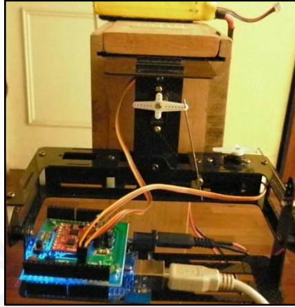
Figura 3.17: Conexiones y montaje realizados para obtener relación pulso de servo y ángulo sentido.
