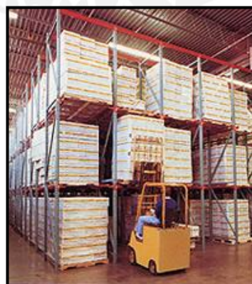
Figura 1.5 Estantería de almacenamiento acumulativa – vista lateral
