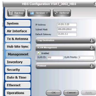
Luego de cambiar la dirección IP, el RADWIN manager se desconectará automáticamente. Para volver a conectarse, es necesario que la computadora se configure en la nueva red configurada.
