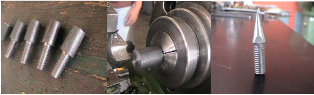
Figura 3.55 Fabricación de los dientes perforadores.
