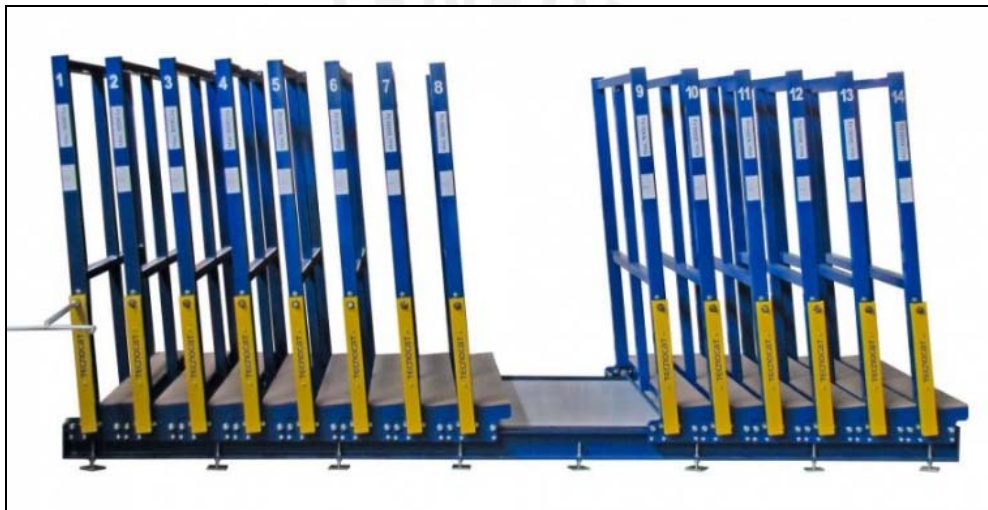
Figura 3.13. Clasificadores manuales para vidrio. Fuente: http://www.tuomas.com/
