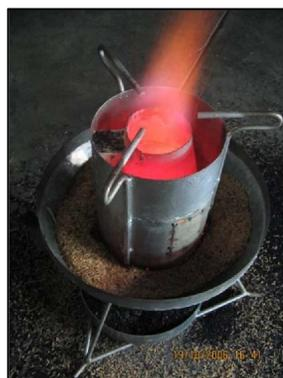
**Figura 2.1 Gasificador con inyección de vapor [2.1]**
