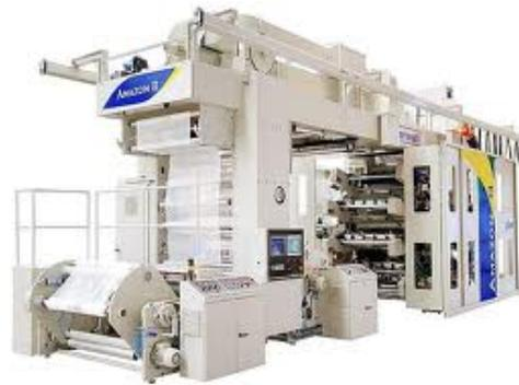
La impresión flexográfica se efectúa a partir de una lámina flexible de elastómero (clisse) sobre la que se efectúa un ataque fotoquímico a partir de un negativo (por cada color) en las áreas desprotegidas por éste, de modo que se reduce su espesor y queda la imagen en relieve. Las áreas de la imagen que están alzadas se entintan y son transferidas directamente al sustrato.
