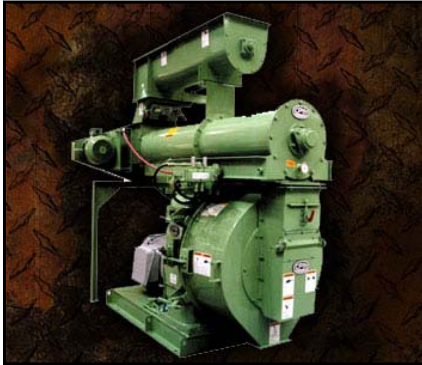
Figura 1.2: Prensa peletizadora con acondicionador simple de un solo paso, Marca California Pellet Mill (CPM).
