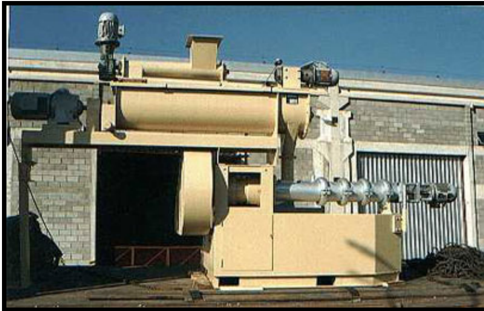
Figura 1.6: Extrusor completo de tornillo simple con alimentador, acondicionador y cortadora.
