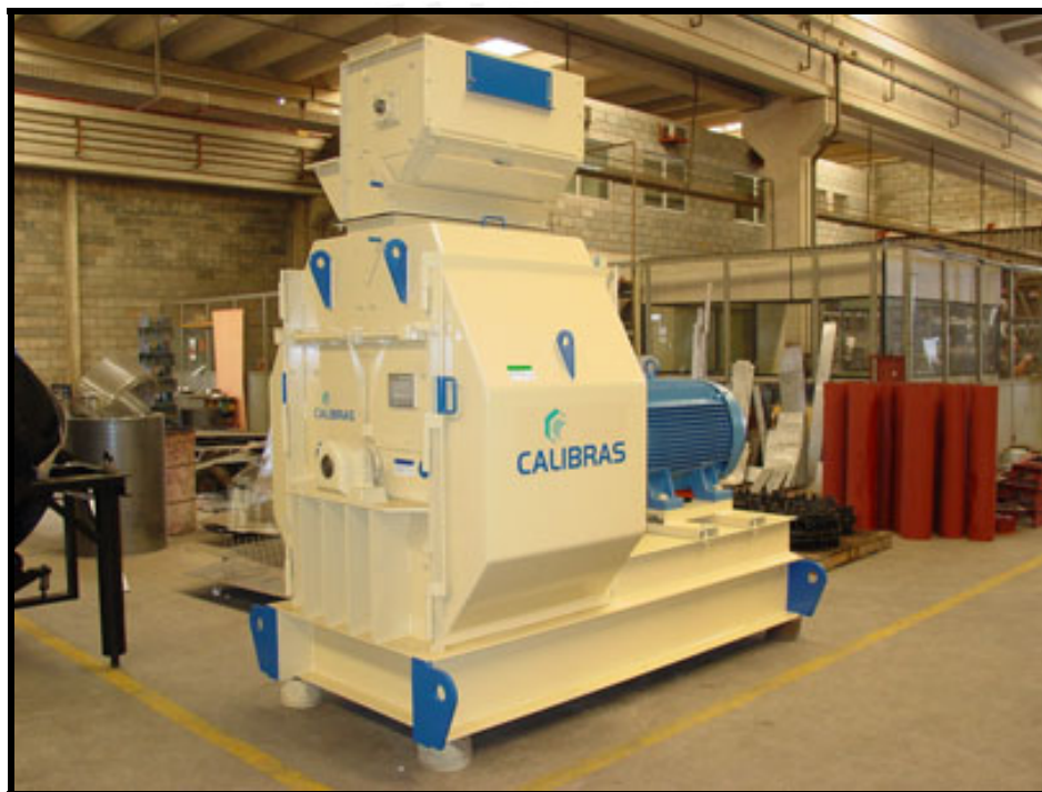
Figura 1.8: Molino de martillos con alimentador rotativo y placa magnética.
