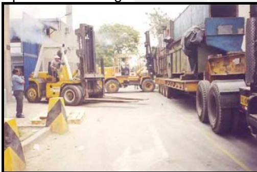
Carga con dos montacargas de 10 ton.
