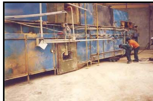
La maniobra se repite para la parte delantera, al final la maquina queda sobre tortugas.
