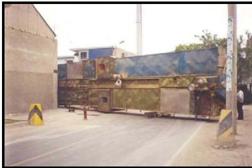
Secador en la calle, en zonas difíciles se coloca planchas en el piso para que desplacen las tortugas
