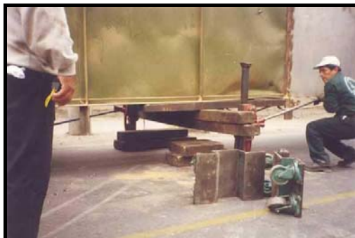
Izaje para colocar cuarterones de madera y para poder colocar la maquina sobre las tortugas con ruedas "locas"
