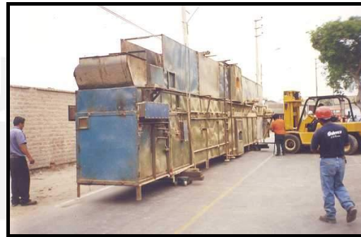
Secador posicionado a lo largo de la pista para carga al camión cama-baja.
