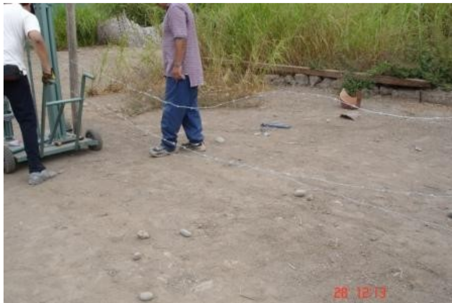
DESENLROLADO DE LOS ALAMBRES DURANTE EL TRANSPORTE DEL EQUIPO.
