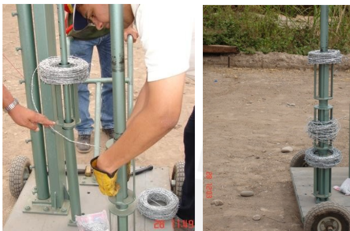
DIVISION Y COLOCACION DE ROLLOS EN EL EQUIPO.
