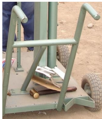
AGARRADERAS PARA EMPUJAR EL EQUIPO.
