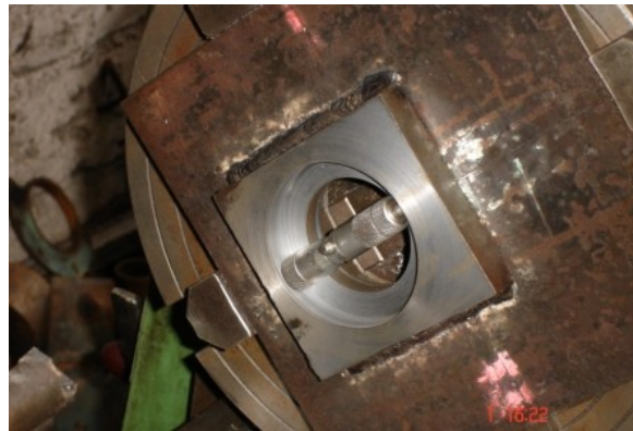
REALIZACIÓN DE AGUJERO PARA RODAMIENTO.
