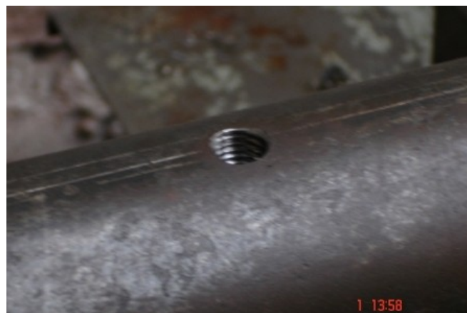
AGUJERO ROSCADO PARA PERNOS TENSADORES.
