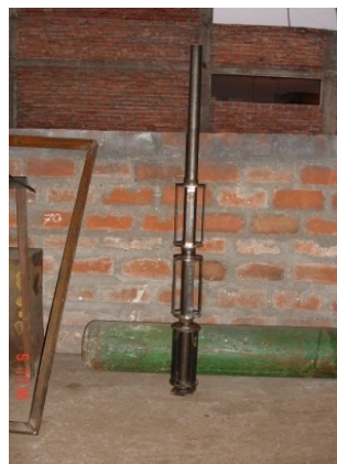
BASE DEL DESEENROLLADOR CON CLINDROS GIRATORIOS.
