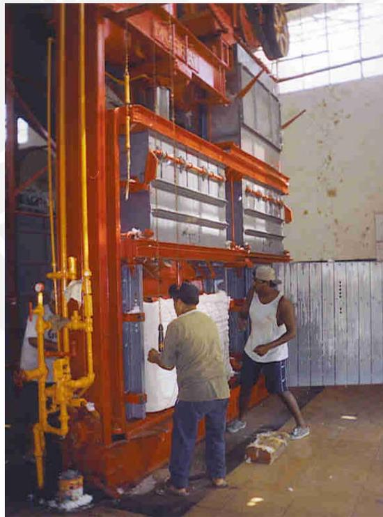
**Fotografía. N°1.4 Máquina empacadora o Tramper**
