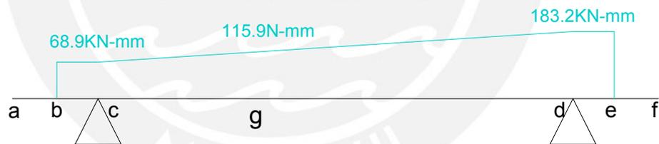
Figura N° 4.6.7 Diagrama de Momento Torsor en eje "Y"
