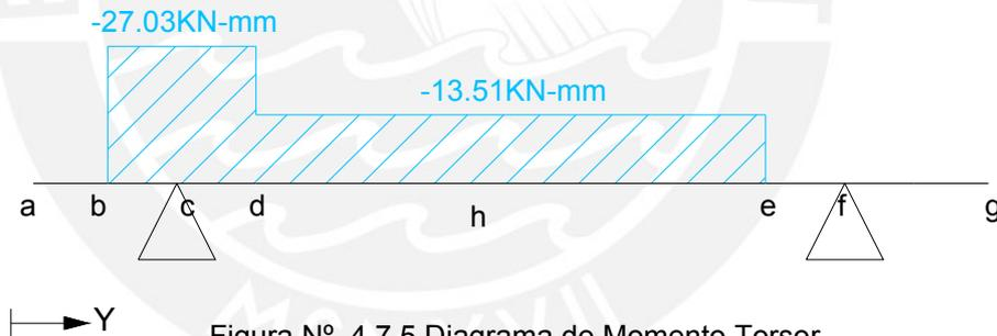
Figura N° 4.7.5 Diagrama de Momento Torsor
