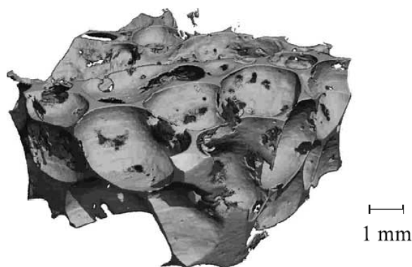
Fig. 3- 6 Microtomografía de rayos X de una espuma de aluminio [17]
