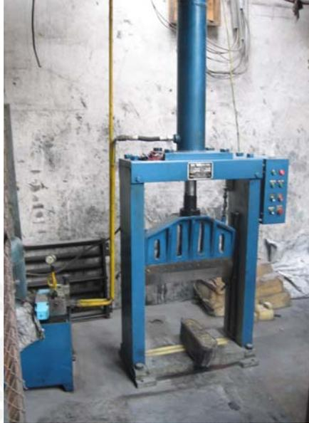
**Figura 3.2. Máquina cortadora de caucho.**
