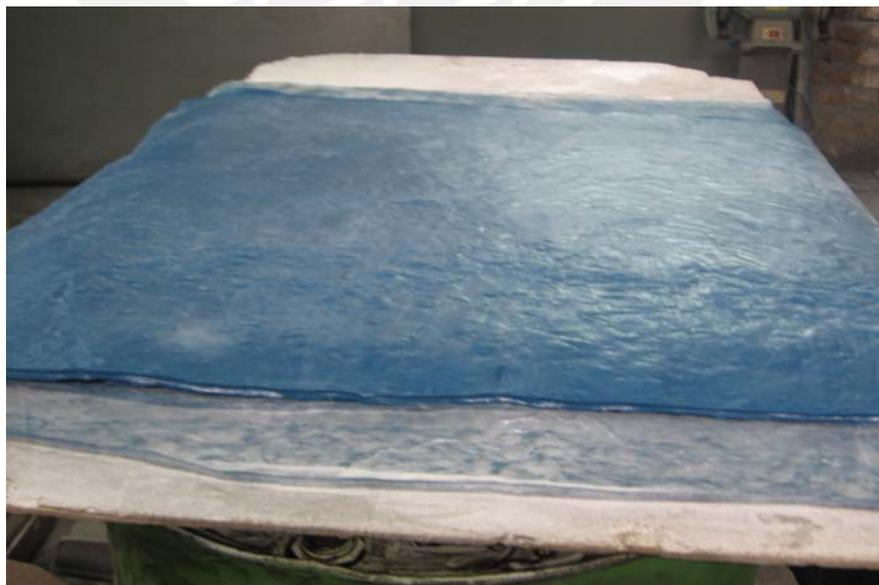
**Figura 3.6. Plancha de caucho resultante del laminado.**
