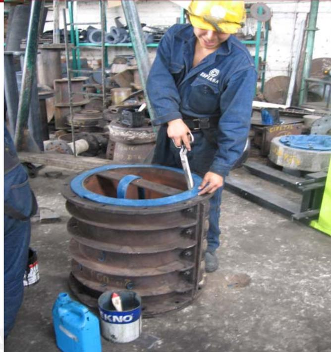
**Figura 3.7. Preparación previa al vulcanizado: inserción del caucho a la matriz.**
