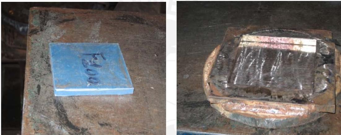
**Figura 2.2. Probeta y matriz a usar para el Diseño de Experimentos EVOP Simplex.**
