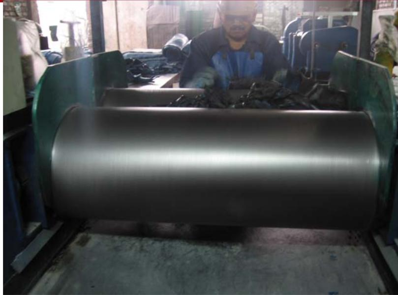
**Figura 3.5. Rodillos del molino de caucho.**
