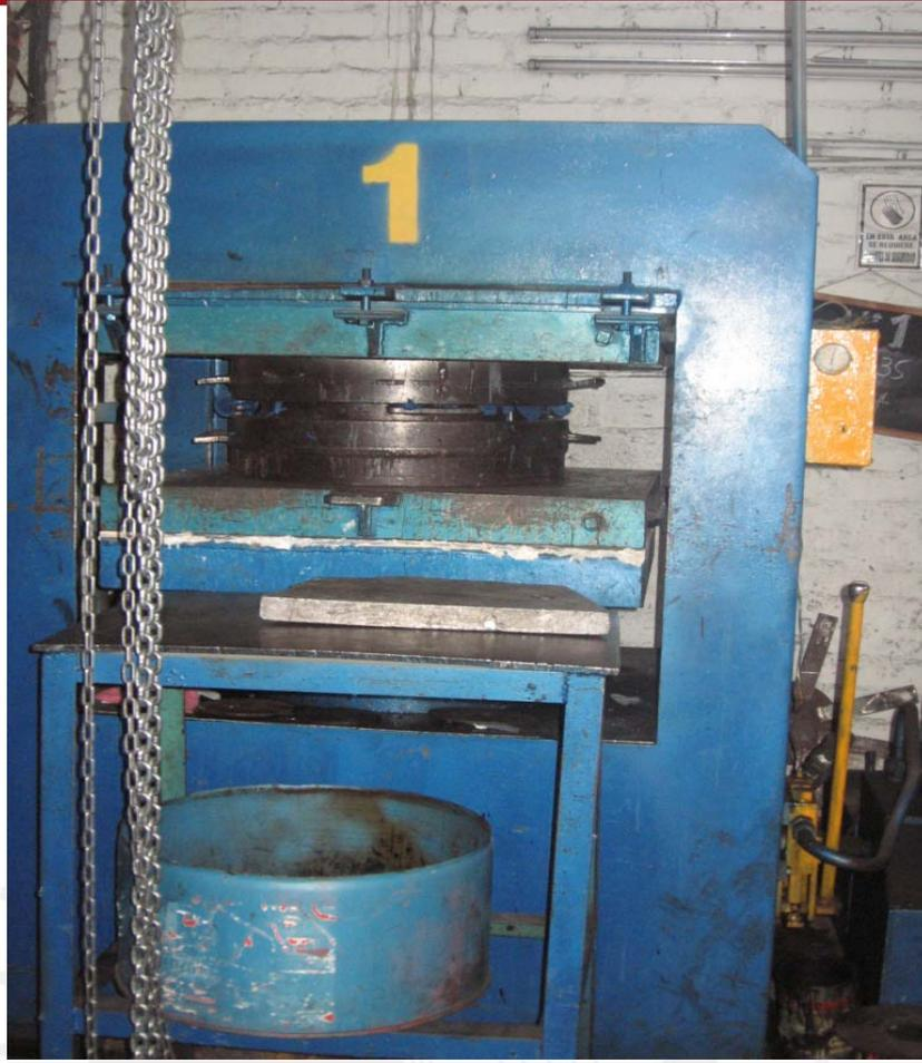
*Figura 3.8. Vulcanización del caucho en la prensa.
