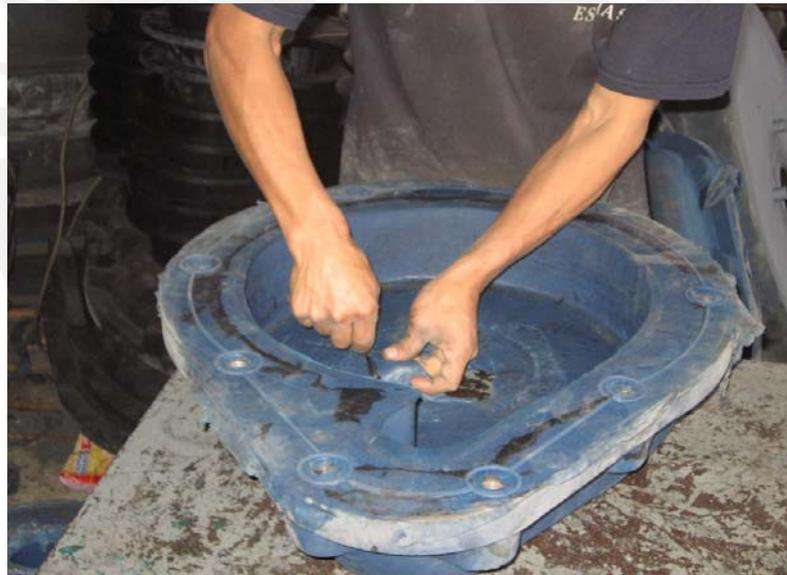
**Figura 3.10. Operación de acabado: corte de rebabas.**
