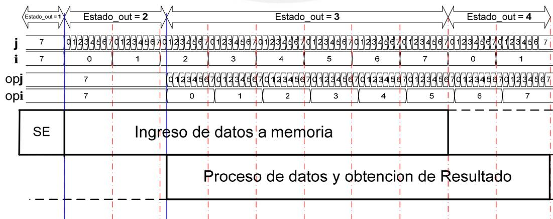
FIGURA 2.3.- SECUENCIA DE LOS CONTADORES DURANTE EL PROCESO DE UNA IMAGEN DE 8X8 PÍXELES
