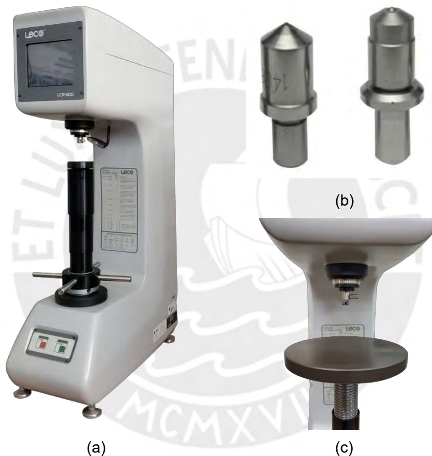
Figura 26. (a) Máquina de Dureza tipo Rockwell LCR-500, (b) Indentadores Rockwell B y C y (c) Base de apoyo de muestras
