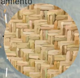
Paneles que funcionan como aislante térmico. Biodegradable, renovable y de bajo coste debido a su composición vegetal de rápido crecimiento y a que es un material local.
