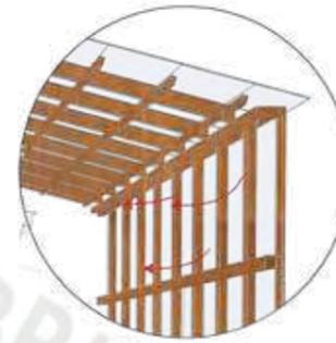
El invernadero permite que atraviese la radiación solar acumulando calor en las superficies con inercia térmica.
