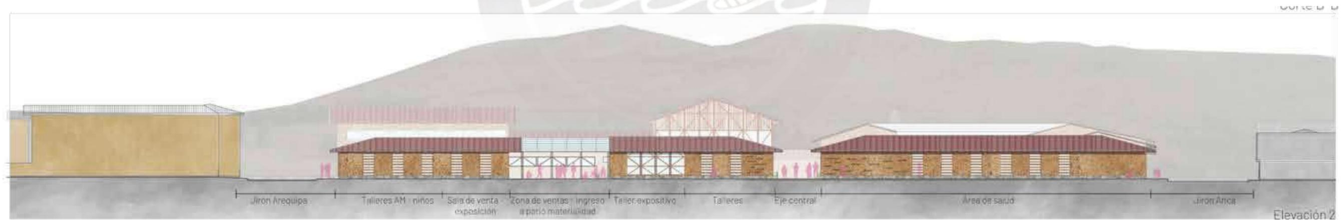
Techo a dos aguas para evocar la **tradición cultural y protección frente a las lluvias**. Además, se usa para crear **transparencias en ciertas zonas** para mayor iluminación y ganancia solar. Se utiliza vidrio y policarbonato antirradiación UV, dependiendo el uso interior pero **con textiles y paneles de totora para evitar el sobrecalentamiento**.
