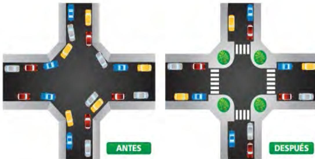
Figura 71: Ejemplo de cómo se puede reducir el radio de giro para disminuir la velocidad de los conductores, y mejorar la circulación de peatones y ciclistas
