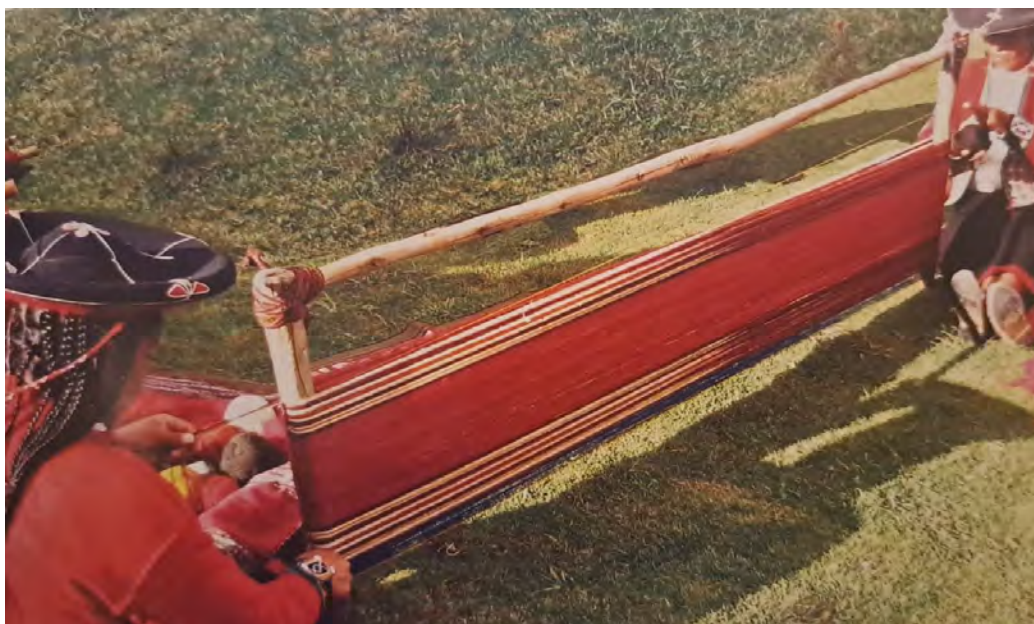
Imagen 8: Proceso de Urdido en Telar Horizontal o ""khallwa"
