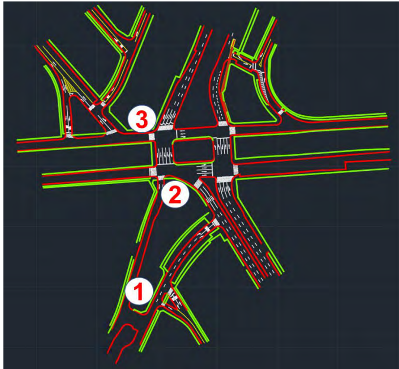
Figura 6.19: Veredas con discontinuidades u obstrucciones
