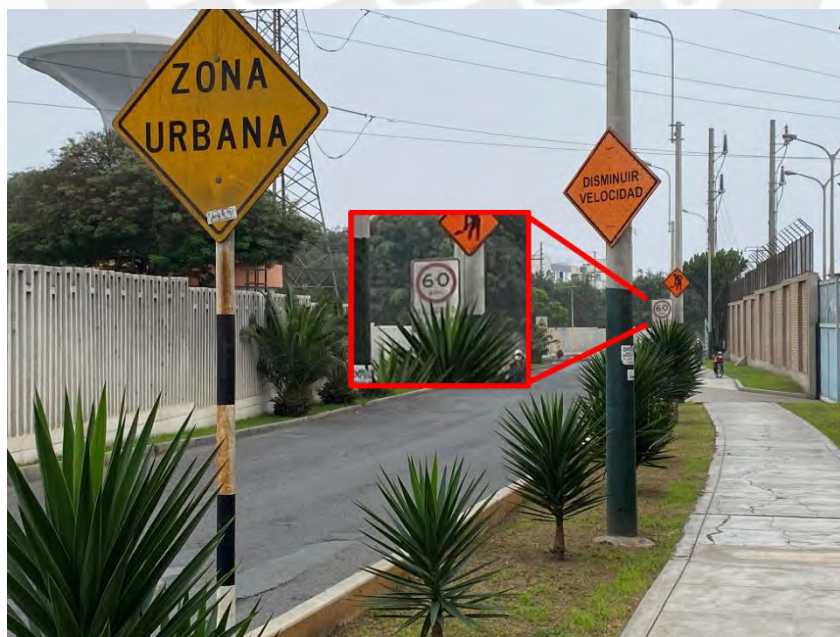
Figura 6.4: Incoherencia en la señalización vertical
