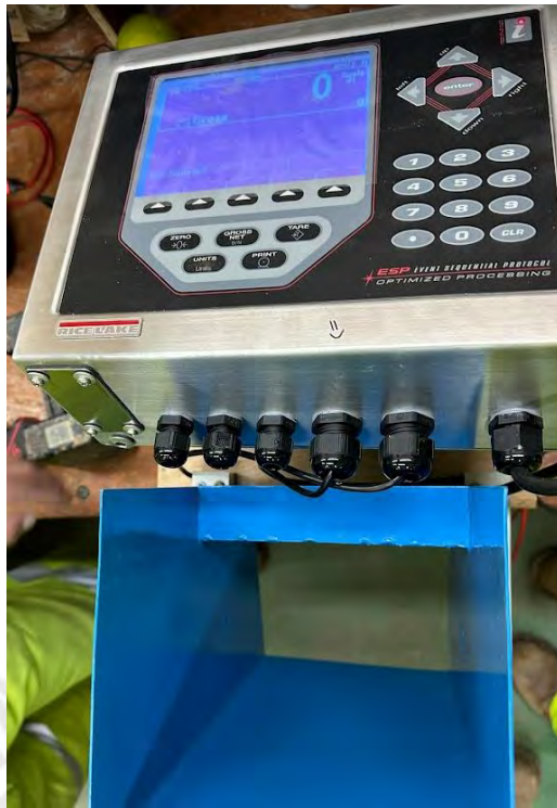
Figura 81 Controlador de peso con celda de carga
