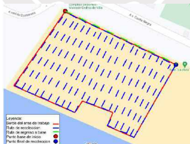
Figura 3.56: Camino en zigzag de limpieza.
