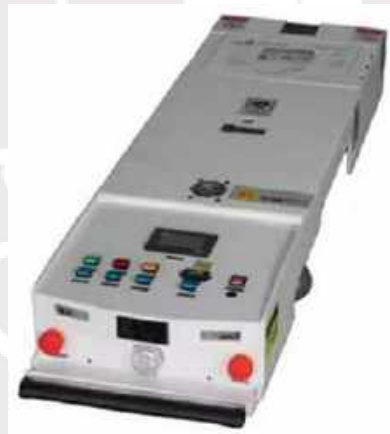
Figura 1.19. Robot AGV con parachoque sensible a la presión.
