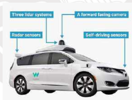
Figura 1.17. Componentes del sistema de navegación autónoma en vehículos WAYMO.
