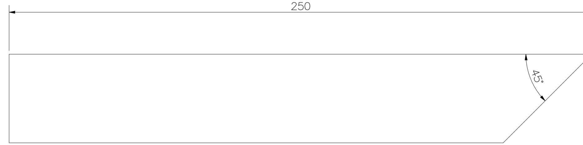
PERFIL LATERAL DERECHO DE 1/4" CIRCUNFERENCIA PIEZA ORIGINADA A PARTIR DE UN PERFIL DE 1/4" DE CIRCUNFERENCIA 38x38mm CORP. MIYASATO CODIGO: T-281
