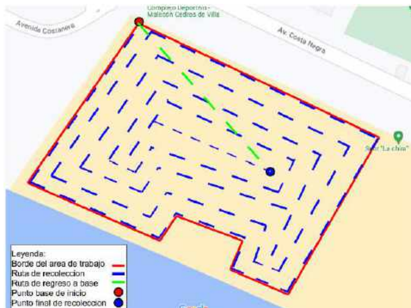
Figura 3.57: Camino concéntrico de limpieza.
