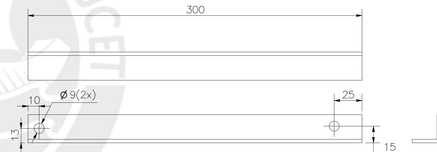
PERFIL HORIZONTAL DE MARCO A 90° PIEZA ORIGINADA A PARTIR DE UN PERFIL DE 1" x " x 1/8" CORP. MIYASATO CODIGO: A-011
