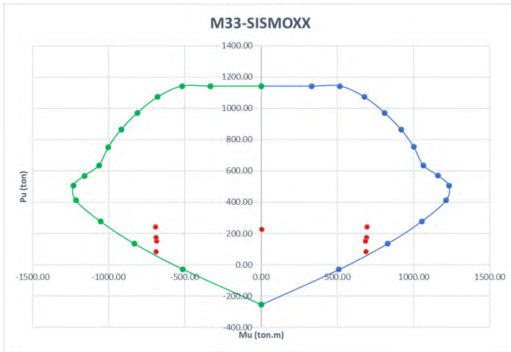
Figura 44. Diagrama de interacción para un sismo X respecto a M33 de PL-05
