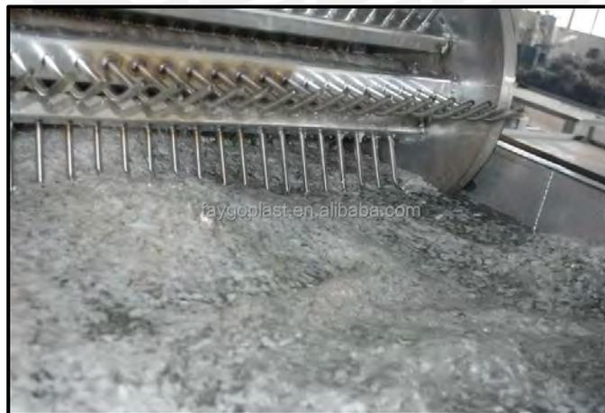
*Nota. Tomado de Alibaba: Arandela Flotadora, Máquina de Reciclaje de Botellas de Plástico PET, Maquinaria de Reciclaje de Botellas de Residuos de Plástico, Línea de Lavado y Secado, por FAYGO, 2023.*
