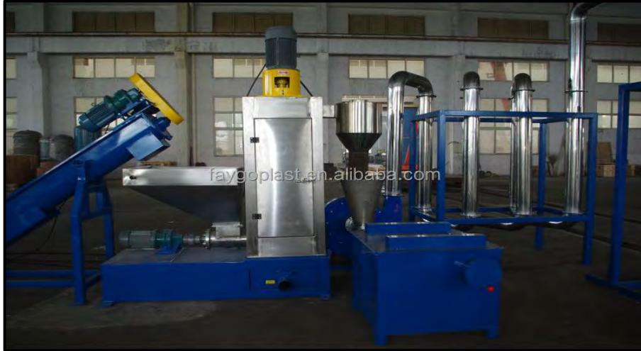
*Nota. Tomado de Alibaba: Sistema de secado inferior, Máquina de Reciclaje de Botellas de Plástico PET, Maquinaria de Reciclaje de Botellas de Residuos de Plástico, Línea de Lavado y Secado, por FAYGO, 2023.*
