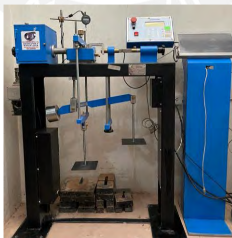
Figura 2.5: Máquina de corte directo.
