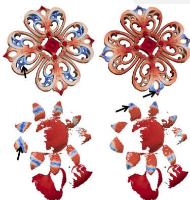
Figura 9. La distancia en el espacio espectral definido por Lipman et al. [8] (Symmetry Factored Distance) medida desde los puntos marcados por las flechas negras. Se usa el azul para pequeñas distancias y rojo para las grandes.
