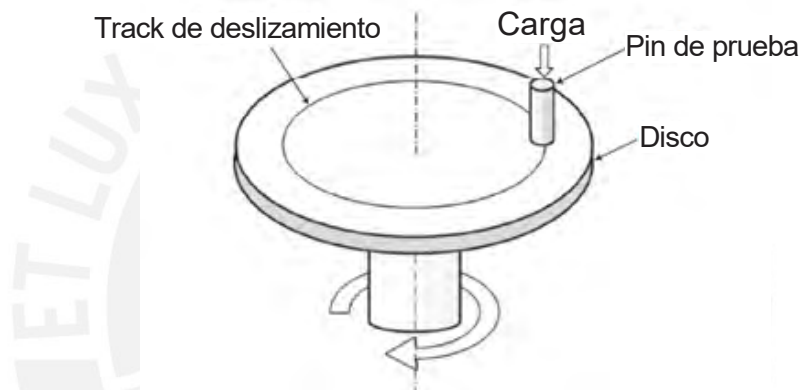
Figura 1-9 Ensayo de desgaste por deslizamiento pin-on-disk (Ahmed & Dakre, 2022).
