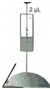
Figura 1-14 Prueba de la gota sésil con 2\mu\text{l} insertados por una aguja, para luego medir el ángulo de la gota ( \theta ) y cuantificar la mojabilidad con la muestra (Terpiłowski et al., 2016).
