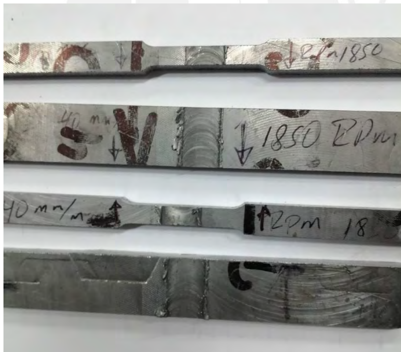
Figura 30. Probetas de dobles y tracción extraídas de cupón soldado Soldadura ejecutada en planchas 6.2 mm- 6.3 mm longitud total de soldeo 95 mm.
