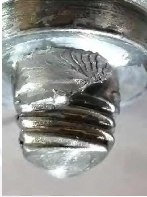
Figura 26. Detalle Pin MX trivex Posterior soldeo longitud de 95 mm a 1800 RPM x 40 mm/min.
