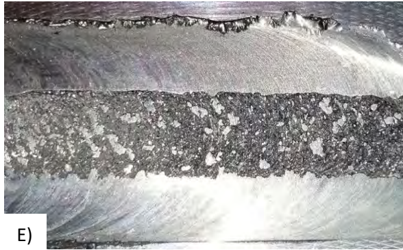
Figura 13. Pruebas preliminares con pin cuadrado inspección superficial de la junta A) C-600/100. B) C-1200/50. C) C-1600/50. D) C-2400/75. E) C-2000/50.
