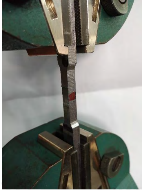
Figura 31. Ensayo de tracción realizado en maquina universal de ensayo Zwick/Roell Z250 de la PUCP.
