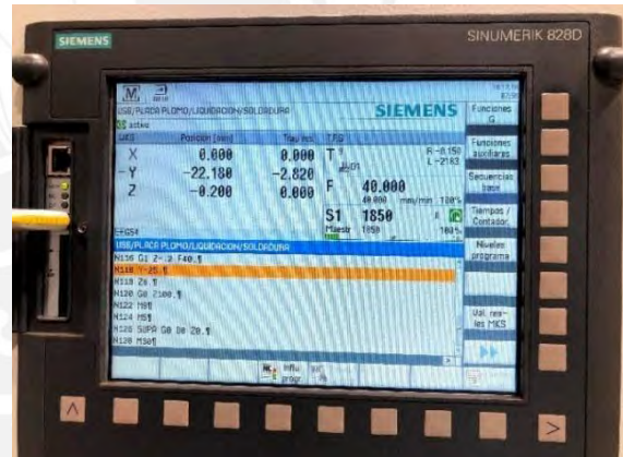
Figura 28. Programación de parámetros de soldeo 1850 RPM x 40 mm/min en centro de maquinado CNC ( Romi D1500).
