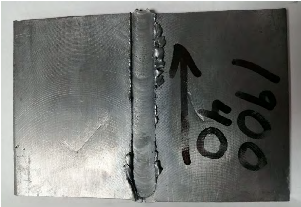
Figura 29. Cupón soldado a partir de dos planchas de 6.25 mm de espesor por longitud total de soldeo 95 mm.
