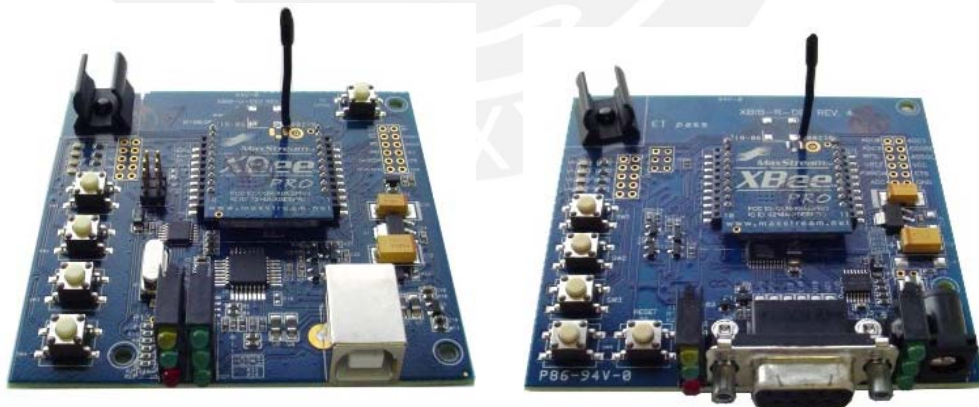
Figura 4.2: Tarjeta de desarrollo XBee USB (izquierda) y RS-232 (derecha) [34]
