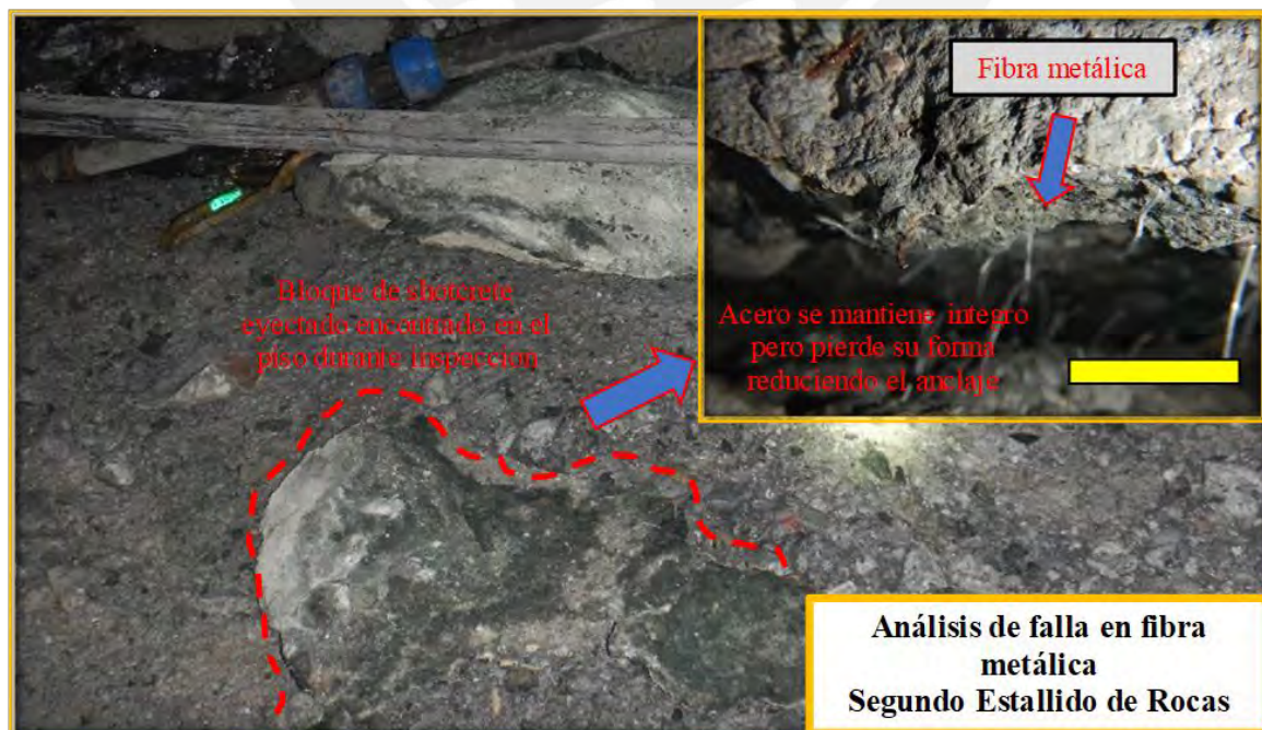
Ilustración 32: Análisis del tipo de falla identificado en el concreto lanzado posterior a un estallido de rocas.
