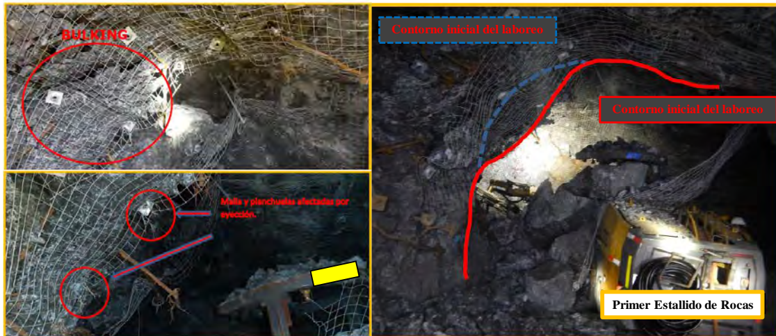
Ilustración 26: Fotografía del pilar fallado luego del estallido de Roca en el Tajeo 8660.
