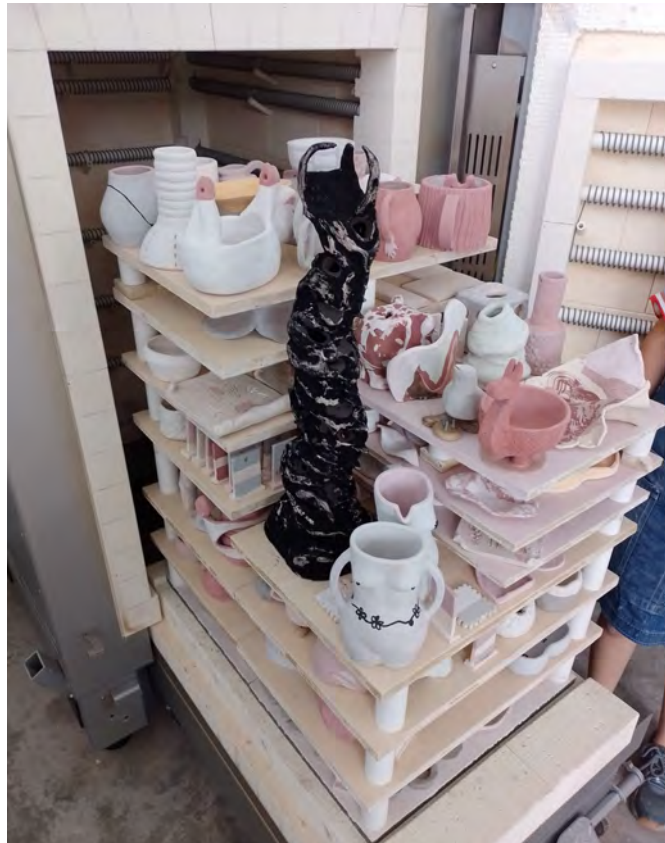
Proceso de Carga de Horno Para Quema de Esmalte
