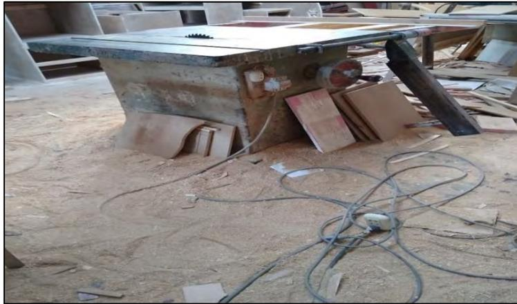
*Figura 18.* Máquina radial con cables sueltos en mala posición
