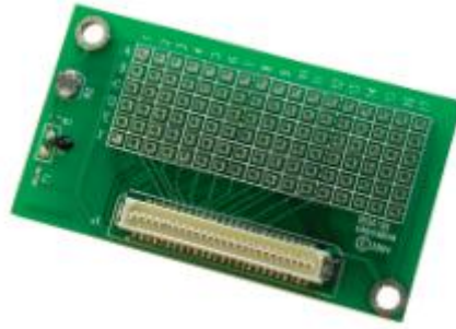
FIGURA 4-7 Tarjeta de expansión MDA100CA con área para desarrollo de prototipos
