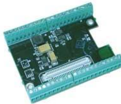
FIGURA 4-8 Tarjeta de expansión MDA300CA con interfaz para sensores externos
