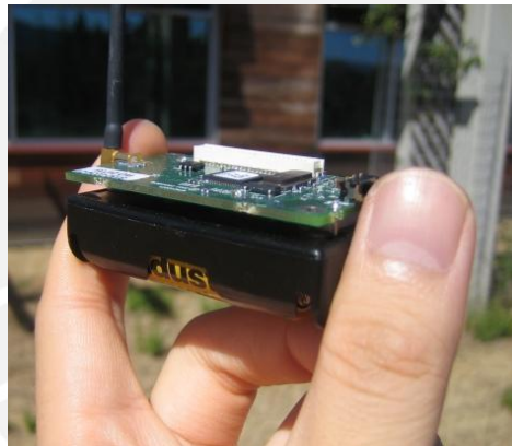
FIGURA 4-1 Mote MICAz de la empresa Crossbow Technology INC.
