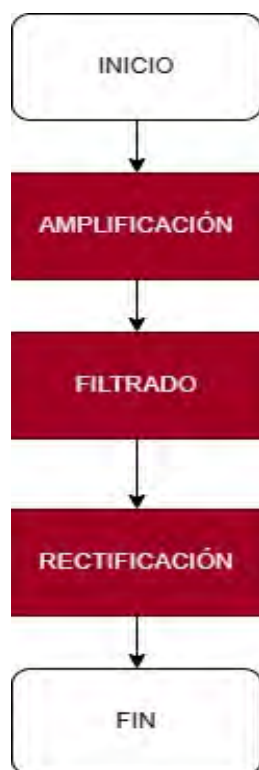
Figura 4.3. Etapas de adquisición de señal EMG.
