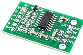
Figura 5.5. Módulo HX711, requiere una alimentación de 5V – 10 mA para su operación.
