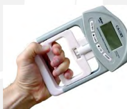
Figura 1.15. Test de la fuerza de agarre empleando un dinamómetro de mano 8 .
