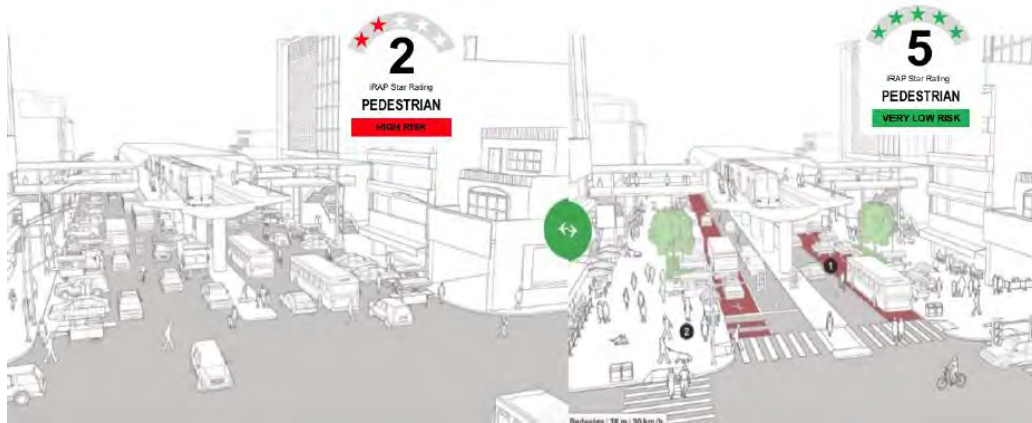
Figura 2.4: Vía de 2 estrellas (izquierda) y de 5 estrellas (derecha) para peatones (iRAP, 2018b)
