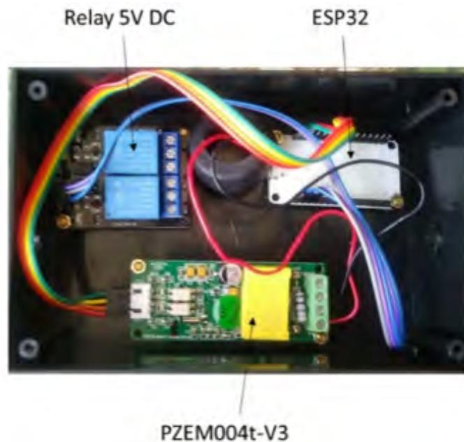
Figura 1.8: Configuración del medidor de potencia inteligente [14]
