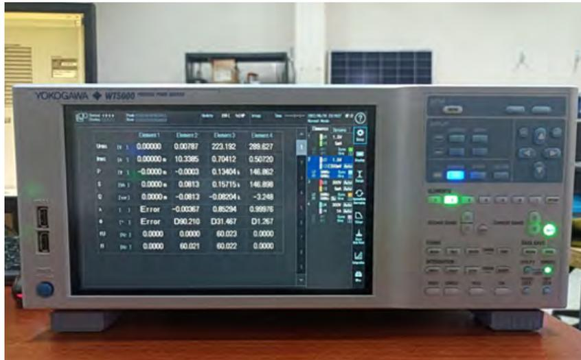
Figura 4.3: Analizador de potencia de precisión WT5000 - Yokogawa
