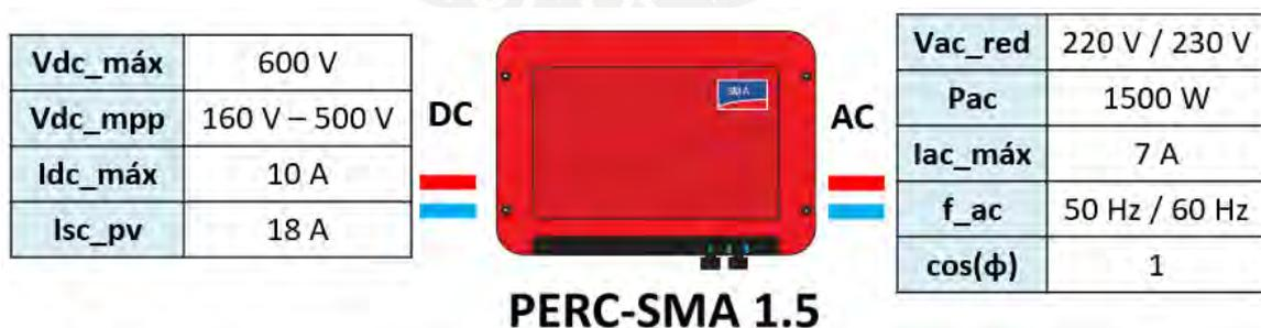
Figura 3.2: Rangos de entrada y salida del inversor SMA
