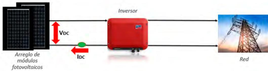
Figura 2.1: Medición de corriente DC y voltaje DC del arreglo fotovoltaico
