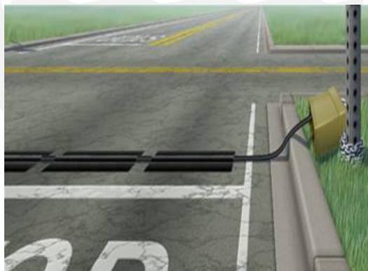
Figura 4.26: Manguera para aforos recubierta con “tapecoat”.
