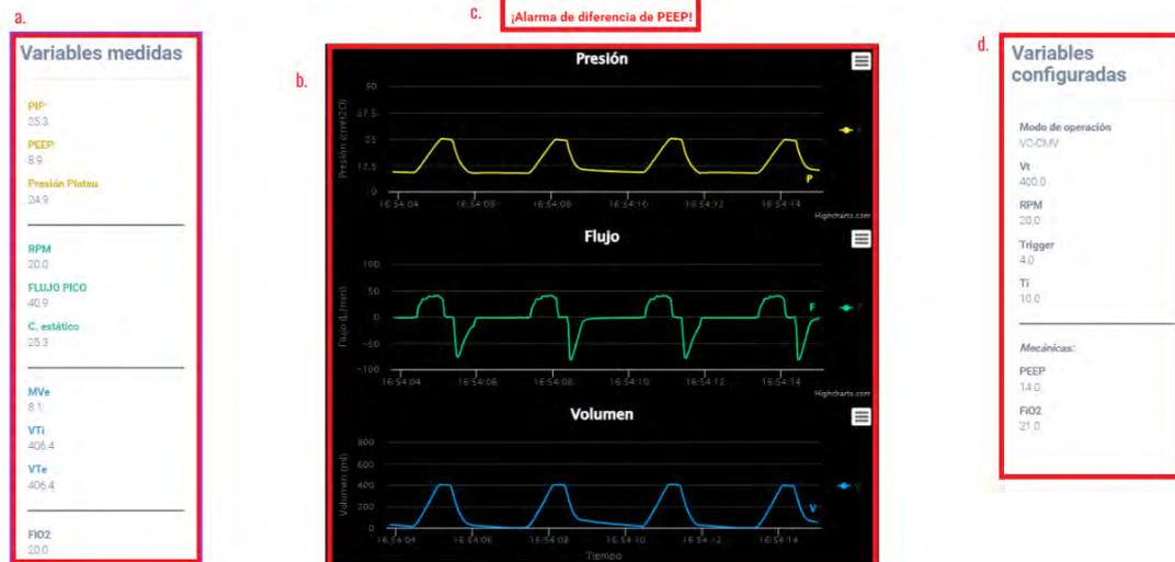
Nota. a) Variables medidas, b) Gráficos con respecto al tiempo, c) Sección de Alarmas, d) Variables configuradas.
