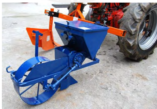
Figura 2.1. Máquina sembradora de rodillo dosificador
