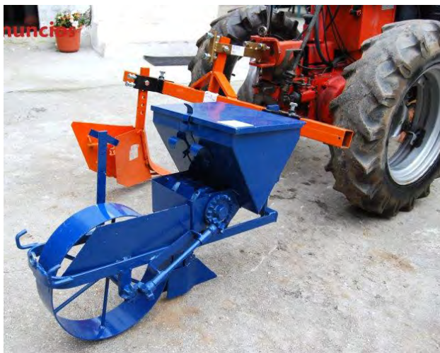
Figura 1.16. Máquina sembradora de rodillo dosificador
