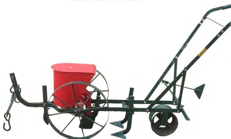
Figura 1.17. Máquina sembradora a tracción animal modelo 2BX-1
