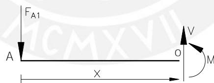
Figura 7.2. DCL del tramo AB
