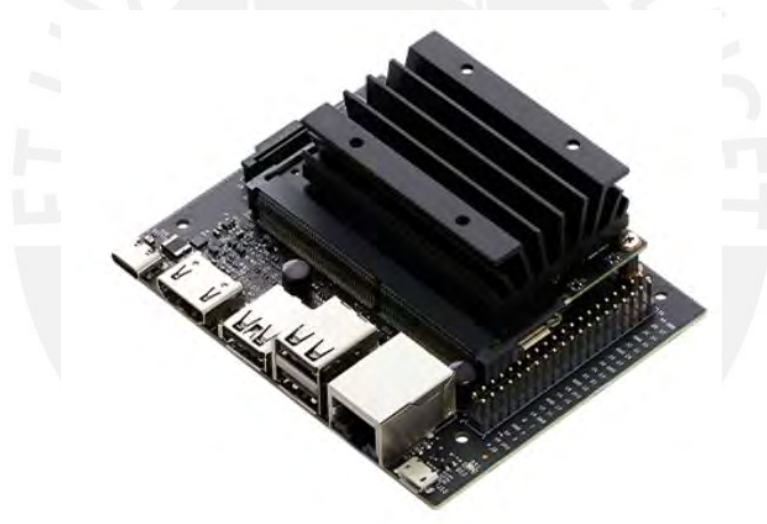
Figura 6. Kit de desarrollo para Jetson Nano. ("Sistemas Integrados NVIDIA para Máquinas Autónomas de Próxima Generación", 2012b)
