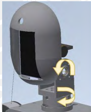
Figura 2.21. Modelo CAD de cabeza robot con 2 grados de libertad.
