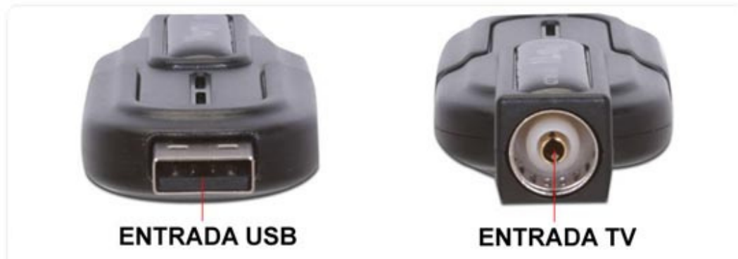
Figura 3.43: Tarjeta para visualizar video en laptop modelo Stick KWorld PlusTV
