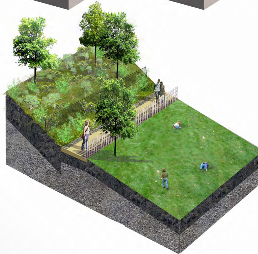
Imagen :Sistema de tierra mecanicamente estabilizada fuente:Govisland
