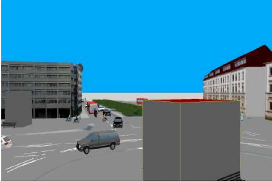
Figura 32. Modelo de cola de vehículos en la Av. Garcilaso De La Vega en VISSIM
