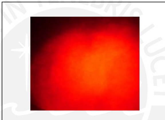
Figura 4.13 Aporte de luz de los 4 LEDs a 1.5 cm.
