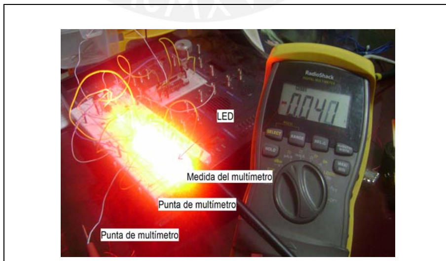
Figura.3.16 Fotografía de la medición de la corriente con el multímetro
