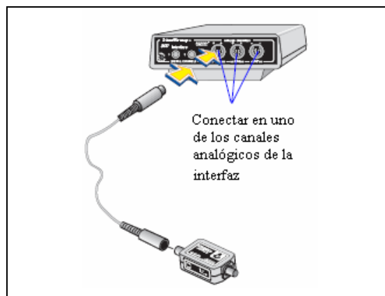
Figura 4.7 Forma de conectar el Sensor de luz a la Interfaz
