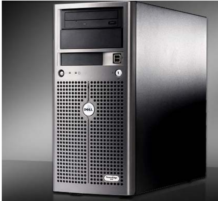
Figura 4.2. Servidor Dell Power Edge 840
