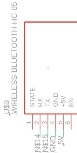
Figura 4.22. Conexión módulo bluetooth.
