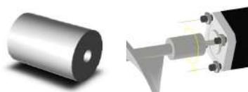
*Figura 4.6.* Unión tornillo – motor.
