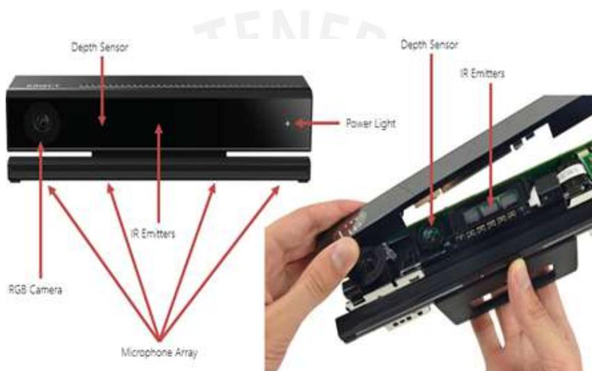
*Figura 2.5.* Sistema de captura de datos Kinect.
