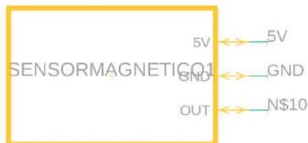
Figura 4.24. Conexión sensor magnético.
