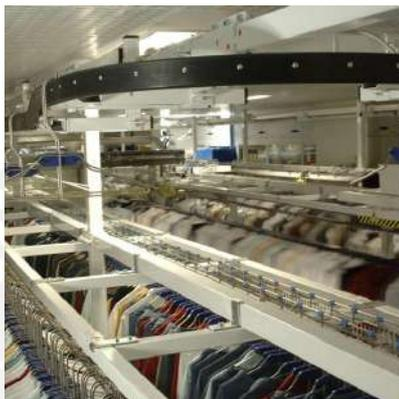
*Figura 2.10.* Sistema dispensador de uniformes.
