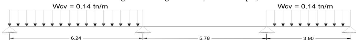
Figura 11 Carga viva en los extremos (Fuente: Propia)
