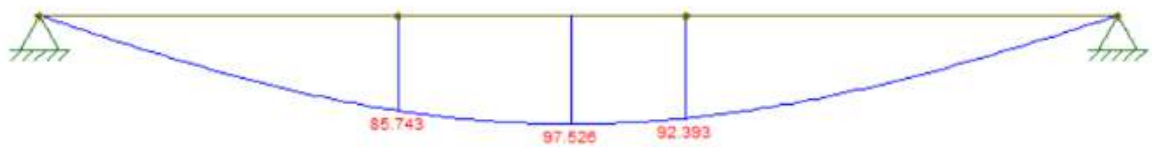
Figura 96. Diagrama de momento de viga de arriostre, en kg.m
