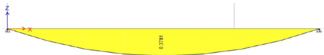
Figura 19. Diagrama de momentos para cargas en servicio de vigueta
