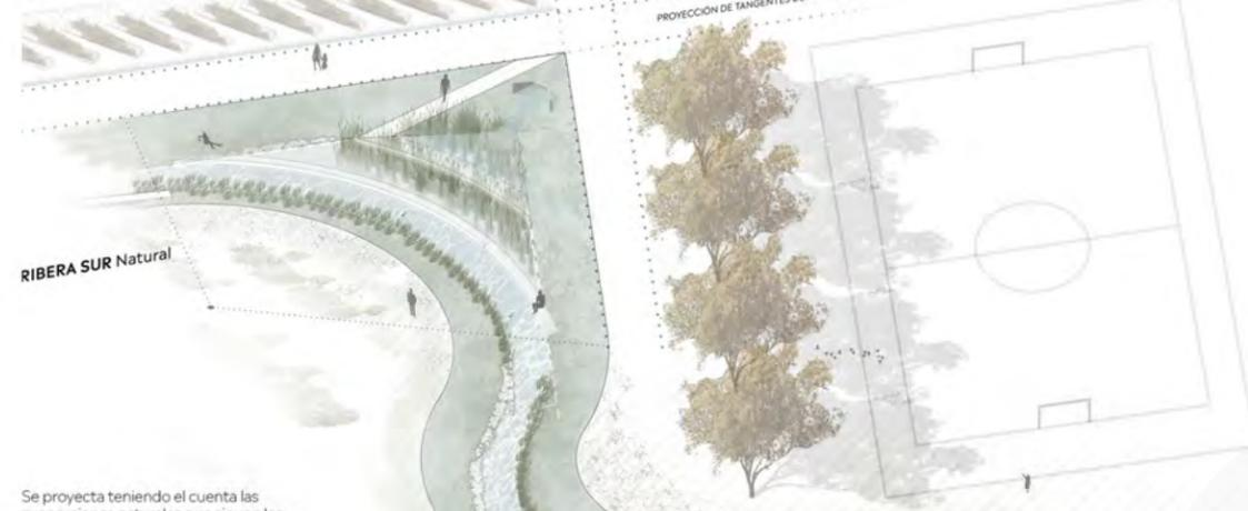
Se proyecta teniendo en cuenta las proporciones naturales que siguen los meandros para reducir los efectos de la erosión y sedimentación dentro del canal, que pudieran modificar la propuesta de forma drástica en el tiempo.
