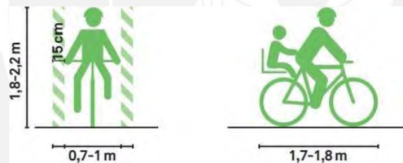
Figura 5. Ancho mínimo de diseño de ciclovía según ciclista. Fuente: NACTO (2016)
